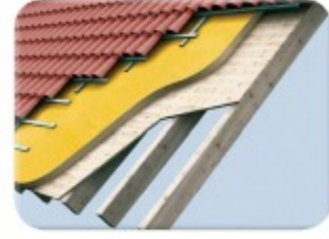
Çatıya cam yünü kaplatmış.
