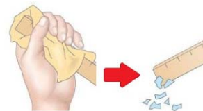
Sürtünme ile elektriklenen cetvel kağıt parçalarını çeker
