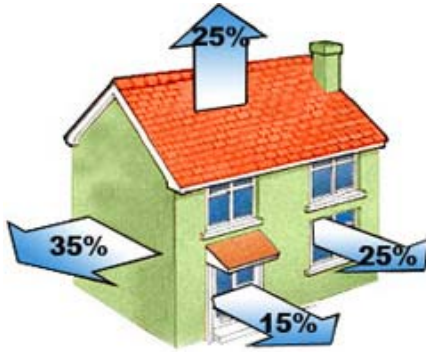
Binada ısı kaybı
