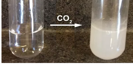
Karbondioksit gazı kireç suyunu bulandırır.
